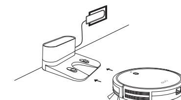
**💡** Caricare completamente RoboVac prima dell'utilizzo. L'indicatore LED su RoboVac emette una luce arancione lampeggiante durante la ricarica e blu fissa quando è completamente carico.
