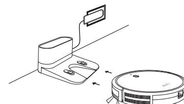
**Chargez complètement le RoboVac avant utilisation. Le voyant LED sur le RoboVac est en respiration orange pendant la charge, et en bleu fixe lorsque la batterie est complètement chargée.**
