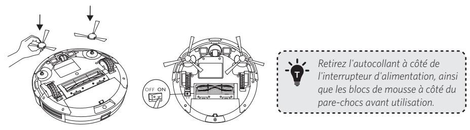
**Retirez l'autocollant à côté de l'interrupteur d'alimentation, ainsi que les blocs de mousse à côté du pare-chocs avant utilisation.**
