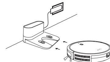
**💡** Laden Sie den RoboVac vor der Verwendung vollständig auf. Das LED-Licht am RoboVac blinkt während des Ladevorgangs langsam in Orange. Wenn der Akku vollständig geladen ist, leuchtet das LED-Licht blau.
