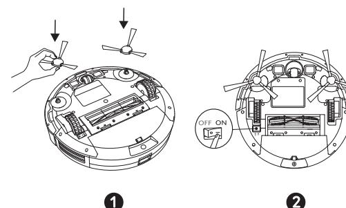
**💡 Quite el adhesivo que hay junto al interruptor principal y los bloques de espuma junto al paragolpes antes de usar el dispositivo.**
