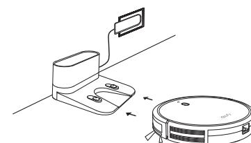
**💡 Cargue el RoboVac por completo antes de usarlo. El indicador LED del RoboVac parpadea en naranja mientras se carga y cambia a azul fijo cuando está totalmente cargado.**
