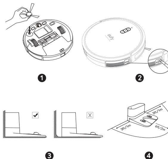
Quite el adhesivo que hay junto al interruptor principal y los bloques de espuma junto al paragolpes antes de usar el dispositivo.
