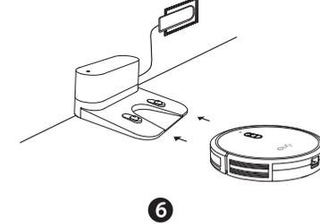
Die LED-Anzeige an der ►||-Taste blinkt während des Ladevorgangs langsam in Orange. Wenn der Akku vollständig geladen ist, leuchtet die LED dauerhaft blau.
