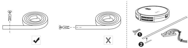
**g** Coloque barreras físicas o las tiras delimitadoras delante de chimeneas y zonas en las que el RoboVac podría sufrir daños.
