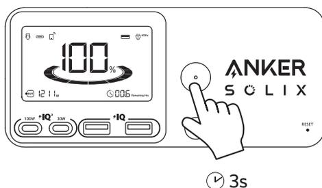
Appuyez sur le bouton d'alimentation principale pendant 3 secondes pour allumer ou éteindre votre station d'alimentation. Lorsque l'indicateur « Batterie restante » apparaît sur l'écran LCD, votre station d'alimentation est prête à charger des appareils.
