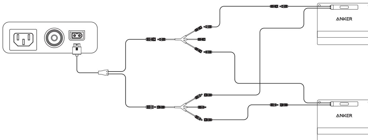
**!** Le connecteur PV vers le câble de charge XT-60 et les câbles d'extension de panneau solaire (3m) sont inclus dans les panneaux solaires Anker SOLIX. Si vous avez besoin de plusieurs panneaux solaires en parallèle, vous pouvez acheter des connecteurs de panneau solaire sur le site officiel d'Anker.
