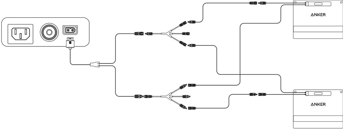
⚡ يتضمن موصل الطاقة الكهروضوئية إلى كابل شحن XT-60 وكابلات تمديد اللوحة الشمسية (3 أمتار) في ألواح Anker SOLIX الشمسية. إذا كنت بحاجة إلى ألواح شمسية متعددة بالتوازي، يمكنك شراء موصلات اللوحة الشمسية من الموقع الرسمي لشركة Anker.
