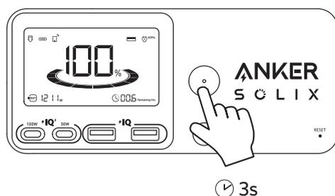
Pulse el botón principal de encendido durante 3 segundos para encender o apagar su estación de energía.
