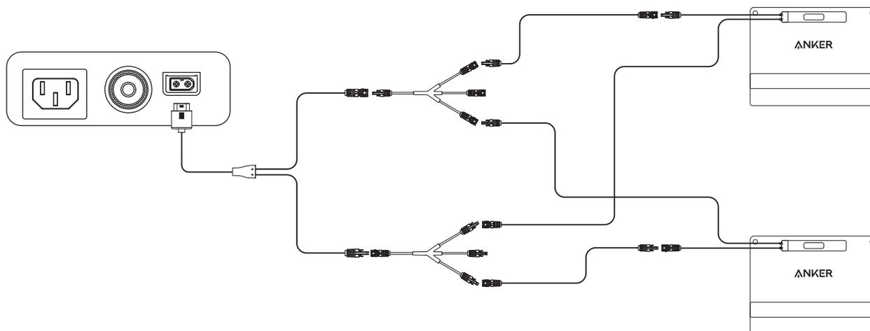
**!** El conector fotovoltaico al cable de carga XT-60 y los cables de extensión del panel solar (3m) están incluidos en los paneles solares Anker SOLIX. Si necesita varios paneles solares en paralelo, puede comprar conectores de paneles solares en el sitio web oficial de Anker.
