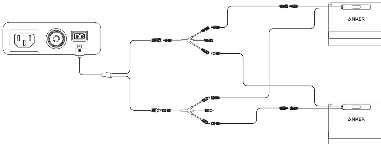
**!** O conector fotovoltaico para o cabo de carregamento XT-60 e os cabos de extensão do painel solar (3m) estão incluídos nos painéis solares Anker SOLIX. Se precisar de vários painéis solares em paralelo, pode comprar conectores de painéis solares no site oficial da Anker.
