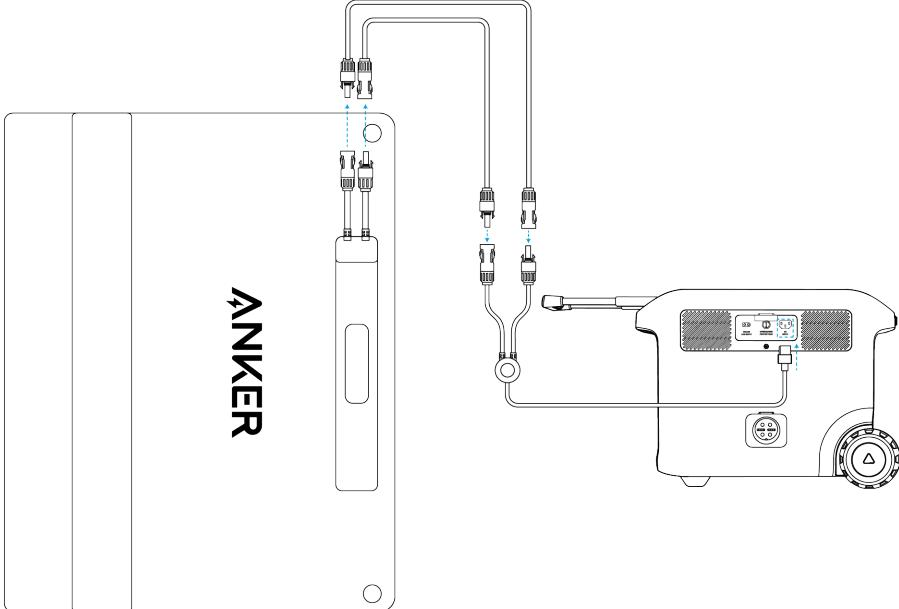
② 如果您的便携电源太阳能输入端口是 DC7909，您可以使用随附的太阳能转 XT-60 充电线和 XT-60 至 DC7909 充电线为其充电。
