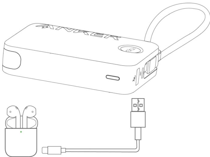
3. 電源ボタンを2度押して低電流モードを終了します。
