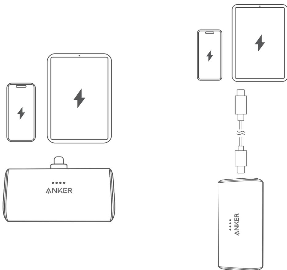
Remarque : En raison du design pliable du connecteur USB-C, il est recommandé de tenir à la fois l'appareil connecté et la banque d'alimentation pendant la charge.
