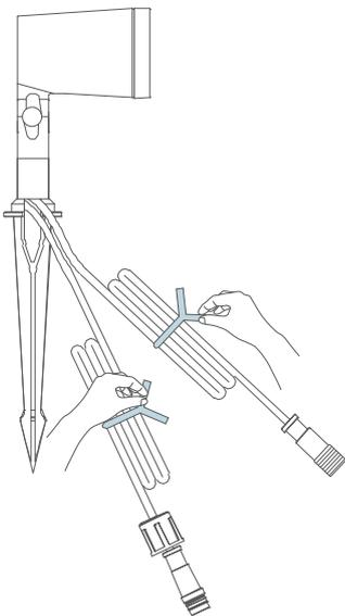
2. Drehen Sie den Erdspeiß und das kurze Rohr im Uhrzeigersinn auf, und ziehen Sie zuerst das Ende ohne wasserdichte Kappe ① aus dem kurzen Rohr heraus, dann das andere Ende ② .
