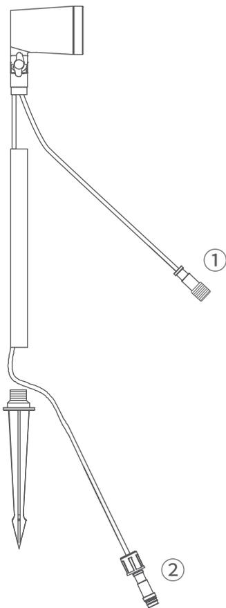
4. Ziehen Sie den Verlängerungsstab und den Bodenanker gegen den Uhrzeigersinn fest, um die Installation abzuschließen.
