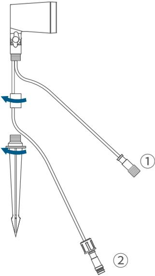
3. Fädeln Sie zuerst das Ende mit wasserdichter Kappe ② durch den Verlängerungsstab und dann das andere Ende ① durch den Verlängerungsstab.
