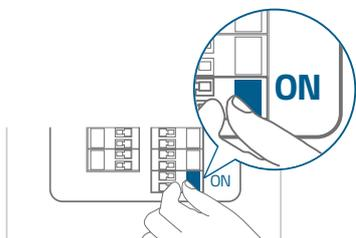
Falls die Flutlichtkamera nicht eingeschaltet ist, schalten Sie vor der Überprüfung der Verkabelung der Flutlichtkamera den Stromkreisunterbrecher aus.
