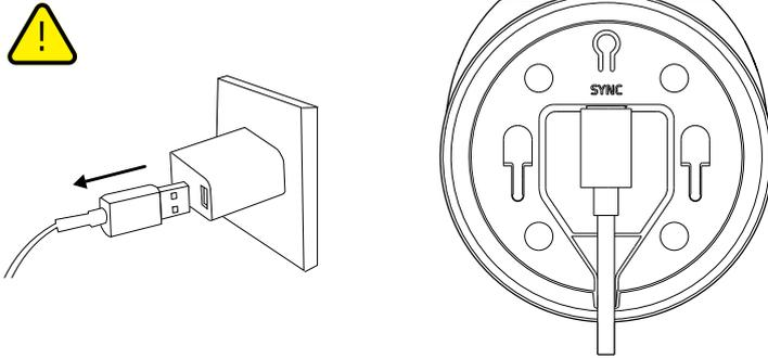
4. Pour le montage mural, placez le câble dans le canal de câble de la plaque de montage.
