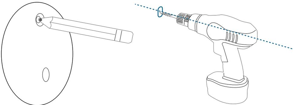
2. Halten Sie die Montageplatte an der Wand und stellen Sie sicher, dass der Pfeil "UP" zeigt, dann befestigen Sie die Montageplatte mit den Schrauben an der Wand oder Decke.
