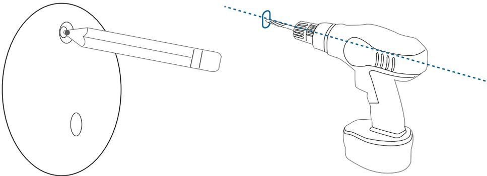
2. Segure a placa de montagem na parede e certifique-se de que a seta "UP" esteja apontando para cima, em seguida, fixe a placa de montagem na parede ou no teto com os parafusos.
