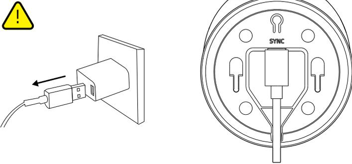
4. Para montagem na parede, coloque o cabo no canal de cabo da placa de montagem.
