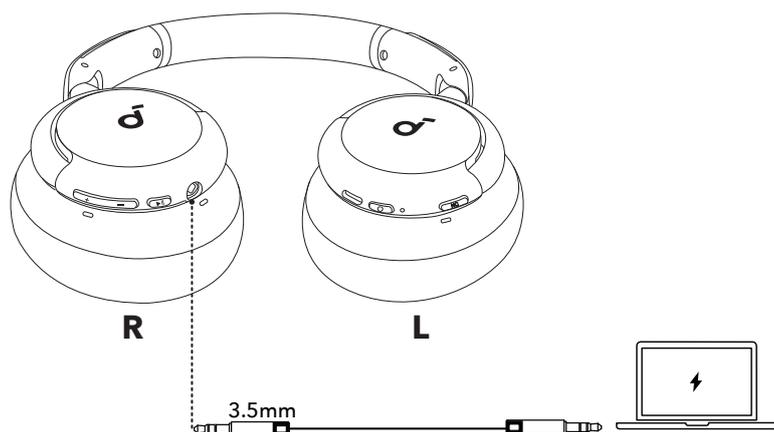
Para reproduzir áudio de um dispositivo externo, conecte o cabo AUX de 3,5 mm fornecido. Isso desativará o modo Bluetooth e os botões não funcionarão durante a escuta com fio.
