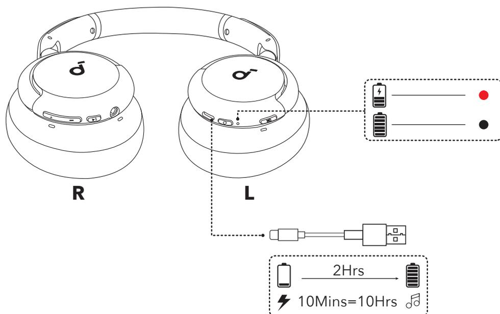
Use o cabo de carregamento USB-C fornecido para conectar seus fones de ouvido a uma fonte de energia. Uma carga completa leva cerca de 2 horas, enquanto 10 minutos de carregamento fornecem até 10 horas de reprodução.
