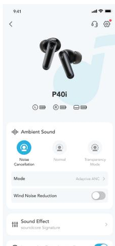
Sie können im soundcore-App den Geräuschunterdrückungs-, Normal- oder Transparenzmodus auswählen. • **Adaptive ANC:** Optimieren Sie die Geräuschunterdrückung, indem Sie sich an Ihre Ohren und Umgebung anpassen.
