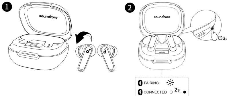
Um den Bluetooth-Kopplungsmodus manuell zu aktivieren, legen Sie die Ohrhörer in die Ladehülle und lassen Sie die Hülle geöffnet. Drücken und halten Sie die Reset-Taste hinter dem Ladegehäuse für 3 Sekunden, bis die LED-Lichtleiste schnell weiß blinkt.
