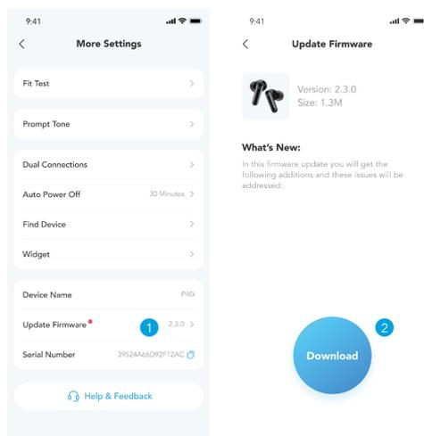
Sie werden informiert, sobald eine neue Firmware-Version erkannt wird, wenn Sie die Ohrhörer mit der App verbinden. Stellen Sie sicher, dass die Ohrhörer in der Ladehülle platziert sind und die Hülle geöffnet bleibt, bis das Firmware-Update abgeschlossen ist. Stellen Sie sicher, dass die Ohrhörer während der Aktualisierung aufgeladen werden, und vermeiden Sie jegliche Nutzung.
