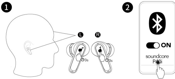
Um die Ohrhörer mit zwei Bluetooth-Geräten gleichzeitig zu verbinden, öffnen Sie zunächst die Soundcore-App, gehen Sie zu Einstellungen und wählen Sie **Dualverbindungen > Dualverbindungen aktivieren > Neues Gerät verbinden**. Nach Abschluss der App-Konfiguration tragen Sie die Ohrhörer und halten Sie dann das Touchpad an beiden Ohrhörern gleichzeitig 3 Sekunden lang gedrückt.
