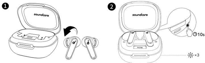
Legen Sie die Ohrhörer in die Ladeschale und lassen Sie diese geöffnet. Drücken und halten Sie die Reset-Taste hinter dem Ladegehäuse für 10 Sekunden, bis die LED-Lichtleiste dreimal schnell weiß blinkt.
