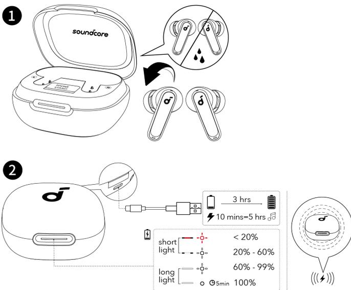
1. Platzieren Sie die Ohrhörer in der Ladeschale und schließen Sie diese.
