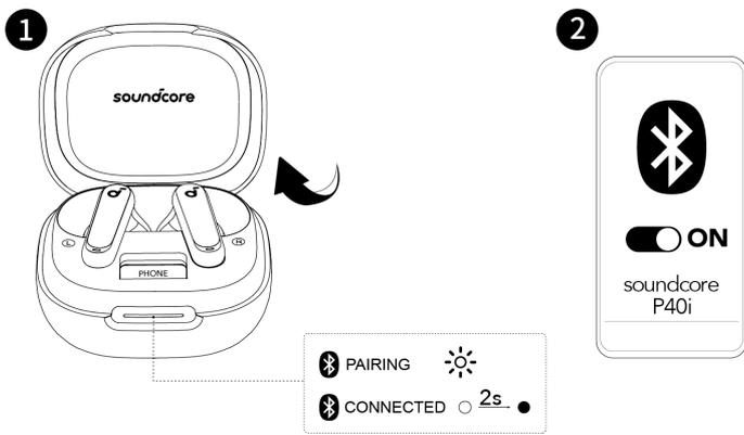
Öffnen Sie die Ladeschale und die Ohrhörer schalten sich automatisch ein und wechseln in den Bluetooth-Kopplungsmodus. Wählen Sie beim ersten Verbinden **"soundcore P40i"** aus der Bluetooth-Liste Ihres Geräts aus.
