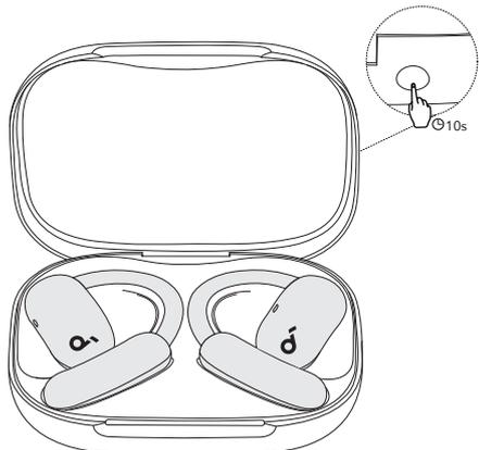
2. Appuyez sur le bouton de l'étui de charge et maintenez-le enfoncé pendant 10 secondes jusqu'à ce que la bande lumineuse LED clignote rapidement en blanc trois fois, indiquant une réinitialisation réussie.
