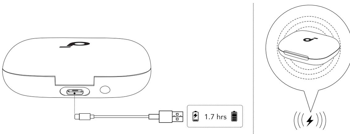
2. Connectez l'étui de charge à une alimentation électrique à l'aide du câble de charge USB-C fourni. L'autre méthode consiste à positionner le boîtier de charge au centre du chargeur sans fil pour effectuer une charge sans fil.
