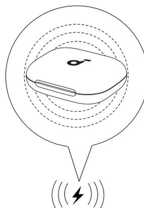
2. Подключите зарядный футляр к источнику питания с помощью прилагаемого кабеля USB-C для зарядки . Или расположите зарядный футляр по центру беспроводного зарядного устройства в случае беспроводной зарядки .
