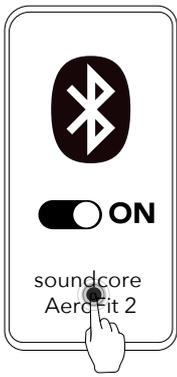
2. Для подключения выберите **"soundcore AeroFit 2"** в списке Bluetooth вашего устройства . Во время сопряжения светодиодная полоса на зарядном футляре начнет мигать . После успешного сопряжения светодиодная полоса будет гореть в течение 1 секунды , а затем погаснет .
