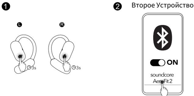
Способ 1. Выполните сопряжение со вторым устройством вручную . Надев наушники , нажмите и удерживайте сенсорные области управления на обоих наушниках в течение 3 секунд , пока не услышите звуковой сигнал для перехода в режим сопряжения . Затем вы можете приступить к сопряжению со вторым устройством .
