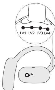
1. Возьмите наушники и сдвиньте заушники до упора в положение LV4, которое обеспечивает максимальную удобную посадку .
