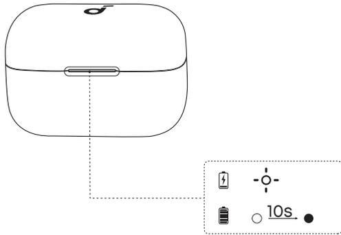
Cuando ambos auriculares estén fuera del estuche de carga, presione el botón del estuche de carga para comprobar el nivel de batería del estuche de carga.
