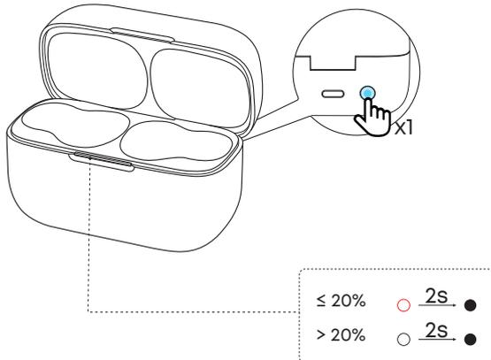
Cuando uno de los auriculares esté en el estuche de carga, presiona el botón del estuche de carga para verificar el nivel de batería de un solo auricular.
