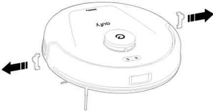
2. Instale la base desmontable presionando ambos lados firmemente hasta que escuche un clic.
