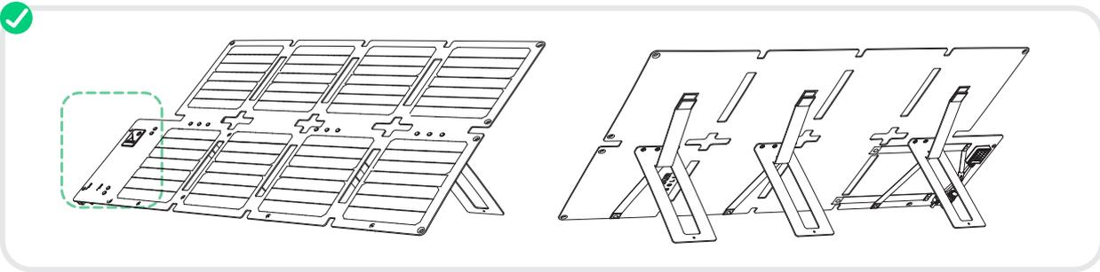
2. Chargez votre station électrique portable avec le câble de charge solaire vers XT-60 inclus. Si vous souhaitez rallonger le câble, utilisez le câble d'extension de 2.5 m inclus.
