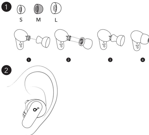
Wählen Sie die Ohrstöpsel, die am besten zu Ihren Ohren passen, und führen Sie einen Passformtest in der soundcore-App durch, um sicherzustellen, dass Sie die beste ANC-Leistung erhalten.
