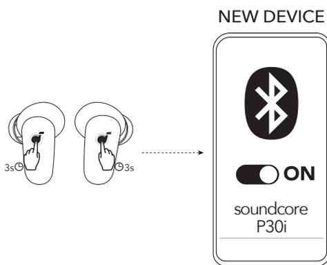
Um sich mit einem neuen Gerät zu verbinden, drücken und halten Sie die Touch-Bereiche beider Ohrhörer gleichzeitig für 3 Sekunden, um in den Pairing-Modus zu gelangen.
