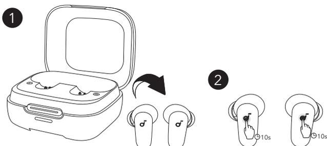
Öffnen Sie das Ladegehäuse und nehmen Sie die Ohrhörer heraus. Drücken und halten Sie dann die Touch-Bereiche beider Ohrhörer gleichzeitig für 10 Sekunden, um zurückzusetzen.
