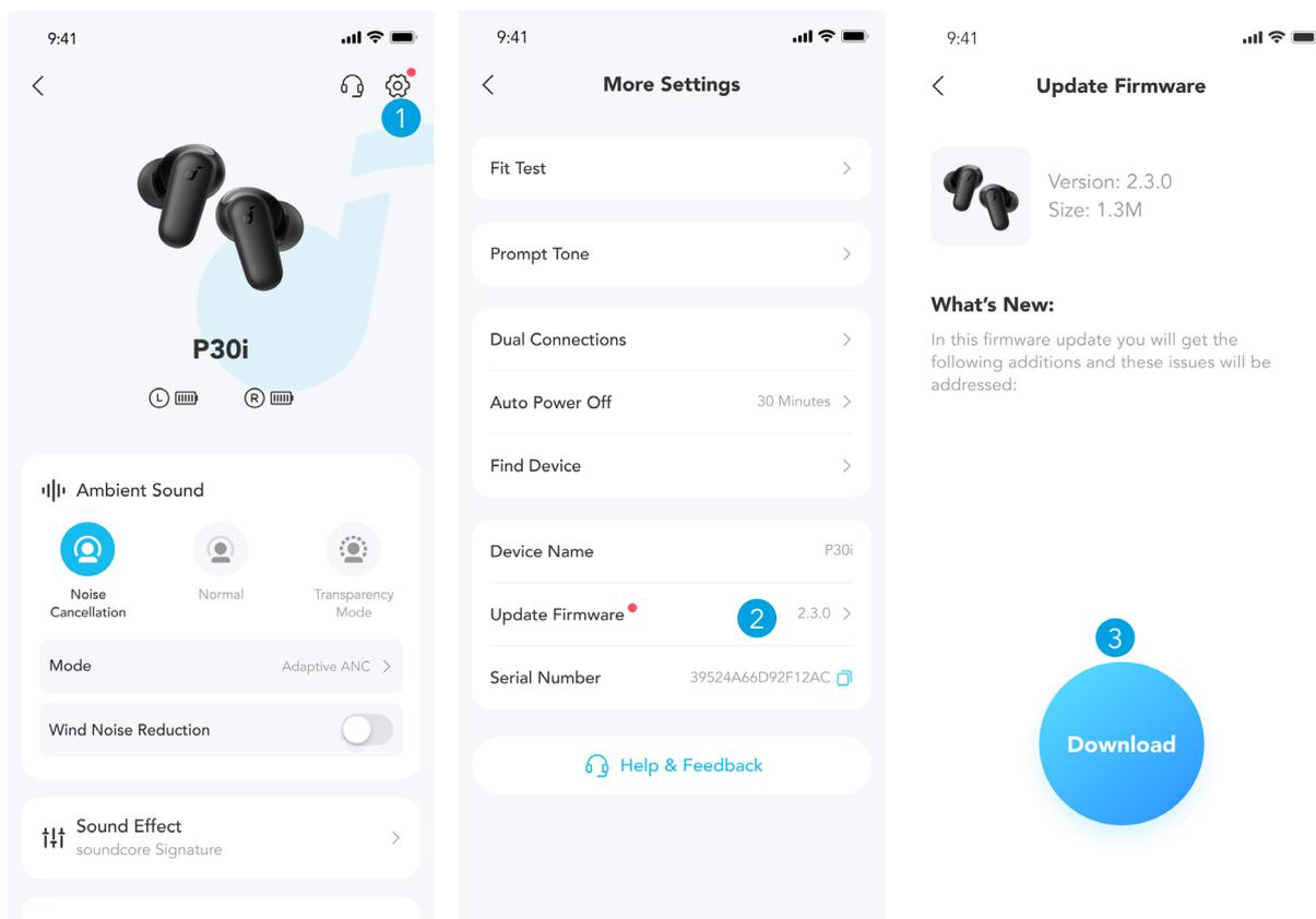
Sie werden informiert, sobald eine neue Firmware-Version erkannt wird, wenn Sie die Ohrhörer mit der App verbinden. Stellen Sie sicher, dass die Ohrhörer außerhalb des Ladegehäuses bleiben, bis das Firmware-Update abgeschlossen ist. Während des Updates jegliche Nutzung vermeiden.
