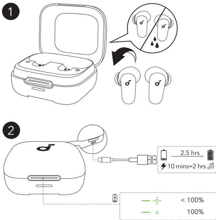
1. Platzieren Sie die Ohrhörer in der Ladeschale und schließen Sie diese.
