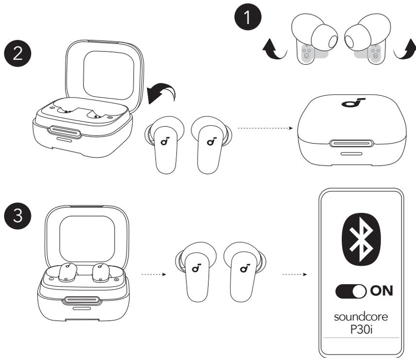
1. Entfernen Sie die Schutzfolie von den Ohrhörern.
