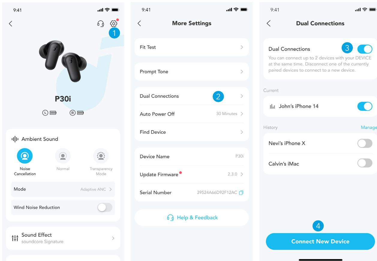
Um die Ohrhörer mit zwei Bluetooth-Geräten gleichzeitig zu verbinden, öffnen Sie zunächst die soundcore-App, gehen Sie zu Einstellungen und wählen Sie **Dual-Verbindungen > Dual-Verbindungen aktivieren > Neues Gerät verbinden**.
