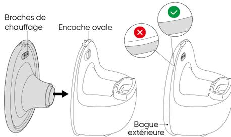
3. Appuyez fermement derrière les broches chauffantes pour une extension complète. Le chauffage peut échouer s'il n'est pas complètement déployé.
