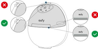
⚡ Le mécanisme de verrouillage entre le corps de pompe et le bec verseur assure une aspiration et un chauffage fiables.
