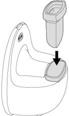
5. Installez le corps de pompe au-dessus du récipient en appuyant fermement afin de sceller l'espace entre le corps de pompe et le diaphragme.
