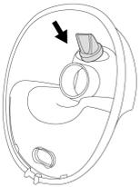
2. Poussez la bride sur le récipient, en vous assurant que les broches de chauffage sont fermement insérées dans l'encoche ovale. Enroulez l'anneau extérieur pour vous assurer qu'il est correctement scellé afin d'éviter les fuites de lait.
