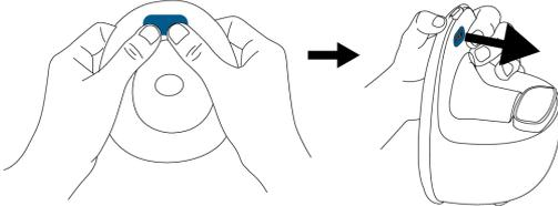
4. Insérez le diaphragme dans la rainure du conteneur, avec le côté concave du diaphragme face au côté bride.
