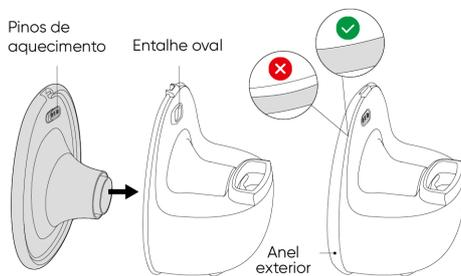
3. Pressione firmemente atrás dos pinos de aquecimento para a extensão completa. O aquecimento pode falhar se não estiver totalmente estendido.
