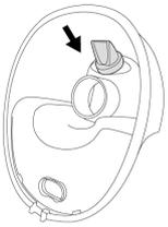
2. Empurre a flange no recipiente, certificando-se de que os pinos de aquecimento estejam firmemente inseridos na ranhura oval. Envolve o anel externo para garantir que esteja devidamente vedado e evitar vazamento de leite.
