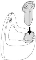
5. Instale o cubo da bomba na parte superior do recipiente, pressionando firmemente para selar o espaço entre o cubo da bomba e a membrana.
