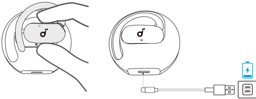
1. Coloque os fones de ouvido de volta no estojo de carregamento.
