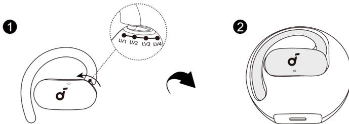
Para desligar, ajuste os ganchos de ouvido para a posição LV1 e coloque os fones de ouvido de volta no estojo.
