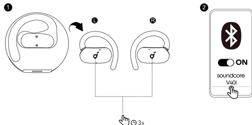
Para entrar manualmente no modo de emparelhamento Bluetooth, retire os fones de ouvido do estojo e, em seguida, pressione e segure as áreas de controle sensível ao toque em ambos os fones por 3 segundos.
