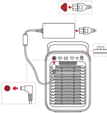
コードをアダプターに差し込みます。次にプロジェクターを電源に接続します。電源に正常に接続されると、プロジェクターの電源ボタンが赤色に点灯します。
