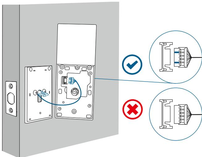
5. Inserte la pieza final en forma de T del teclado exterior en el receptor de la pieza final en forma de T del conjunto interior.
