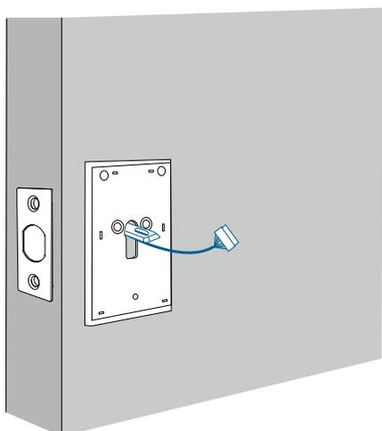
3. Fije el lado con la almohadilla de silicona a la puerta y fije la placa de montaje con tornillos.
