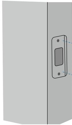
Asegúrese de que la profundidad del orificio del pestillo en el marco de la puerta sea lo suficientemente profunda (25,4 mm/1"); de lo contrario, la calibración podría fallar durante la configuración.
