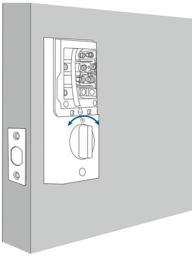
Asegúrese de que el cerrojo esté retraído y que la palometa esté en la posición de desbloqueo; verifique si el cerrojo se mueve correctamente girando la palometa.
