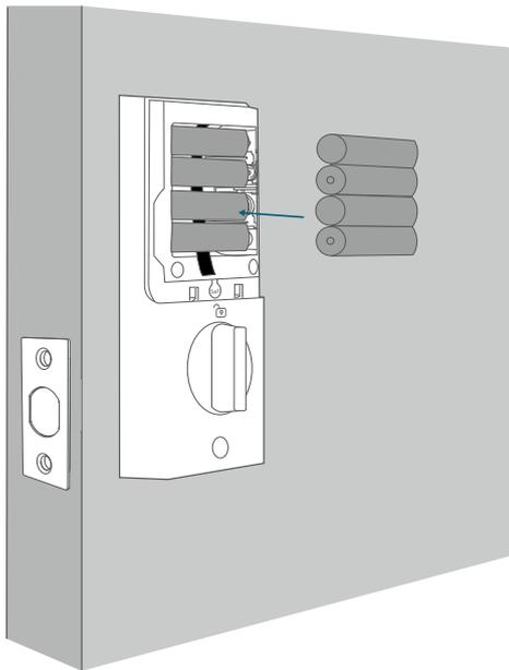
Recordatorio amistoso: Cuando extraiga las pilas, retire primero la capa superior y, a continuación, tire suavemente de la cinta para sacar las pilas restantes del compartimento.
