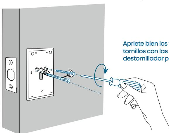
Apriete bien los tornillos. Enrosque los tornillos con las manos y luego use un destornillador para fijarlos bien.
