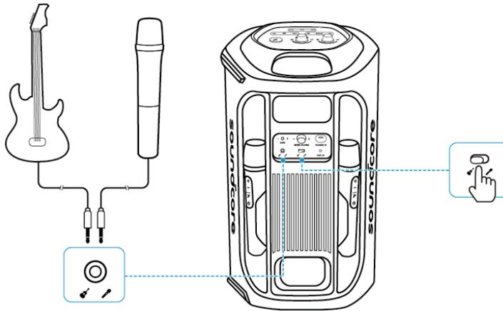
Conecte un micrófono o una guitarra al altavoz a través de cables de audio de 6,5 mm (no incluidos).
