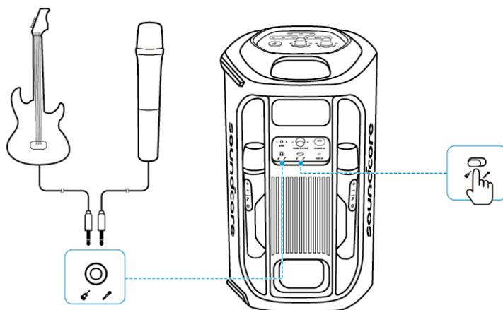
Conecte um microfone ou guitarra ao alto-falante por meio de cabos de áudio de 6,5 mm (não fornecidos).
