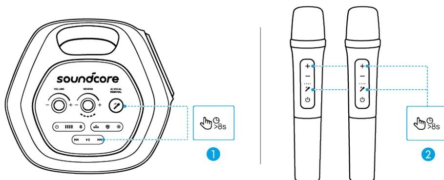
Se os microfones sem fio não se conectarem automaticamente após serem ligados, siga os passos abaixo para emparelhá-los manualmente com o alto-falante.
