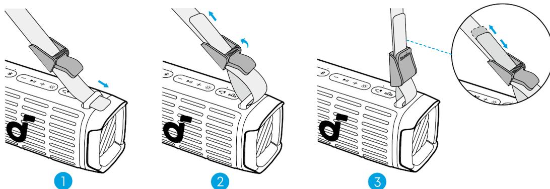
Befestigen Sie den Gurt an beiden Seiten des Lautsprechers. Passen Sie die Gurtlänge gemäß der Abbildung für optimalen Komfort an.
