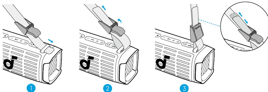
Coloque la correa en ambos lados del altavoz. Ajuste la longitud de la correa según la ilustración para obtener la máxima comodidad.
