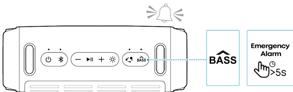
Pressione e segure o botão BassUp por 5 segundos para ativar o Alarme de Emergência em caso de perigo. Quando o alarme for ativado, você pode pressionar qualquer botão no alto-falante uma vez para desligá-lo.
