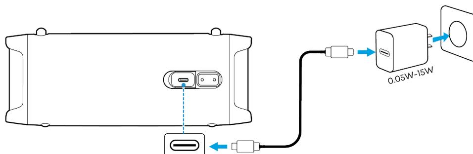
Use o cabo USB-C para USB-C fornecido para conectar o alto-falante e um carregador certificado a uma fonte de energia.
