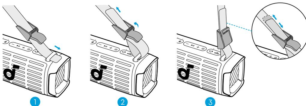
両側のハンドルにストラップを取り付けて、図に従って長さを調整してください。
