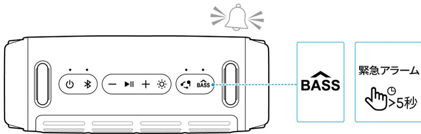
危険な状況の場合、BassUpボタンを5秒間長押しすると、緊急アラームを作動できます。アラームを停止するには、いずれかのボタンを押してください。
