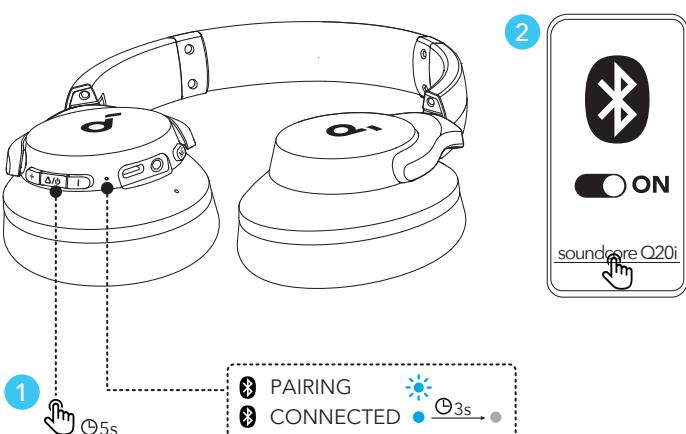
Za ručno uključivanje Bluetooth načina uparivanja, isključite slušalice i pritisnite višenamjensku tipku na 5 sekundi.
