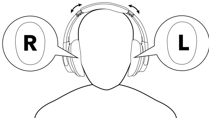
Nosite slušalice s oznakom "L" na lijevom uhu i oznakom "R" na desnom uhu. Prilagodite duljinu obruča za glavu za udobno pristajanje.
