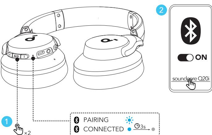
Da biste povezali slušalice s dva uređaja istovremeno, osigurajte da su povezane samo s jednim uređajem. Zatim dvaput pritisnite višenamjensku tipku kako biste se povezali s drugim uređajem. Također možete omogućiti Dual Connections putem aplikacije soundcore. U aplikaciji soundcore idite na **Dual Connections > Omogući Dual Connections > Poveži novi uređaj**.
