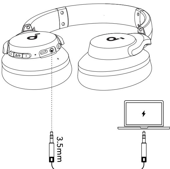
Reproducirajte zvuk na vanjskom uređaju priključivanjem 3,5 mm AUX kabela. Žičano slušanje automatski će isključiti Bluetooth način rada.
