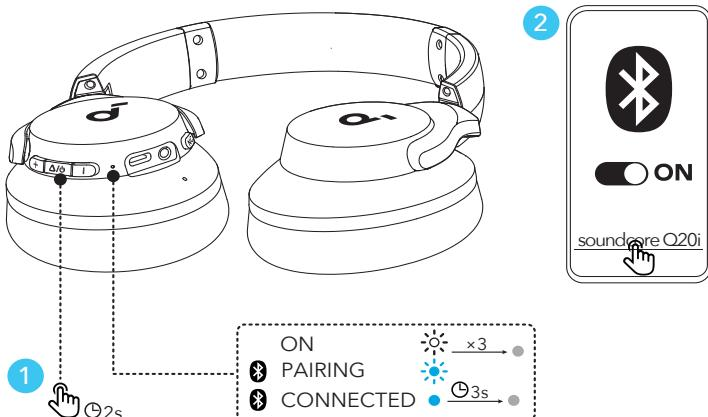
Pritisnite i držite višenamjensku tipku 2 sekunde za uključivanje. Slušalice će automatski ući u način uparivanja putem Bluetootha prilikom prvog povezivanja.
