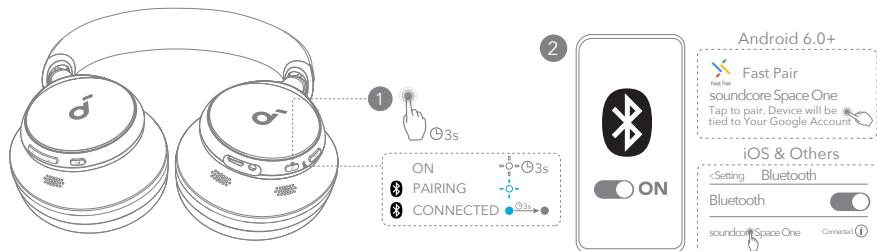
**Automatsko uparivanje:** Pritisnite i držite dugme za napajanje 3 sekunde da biste uključili uređaj. Slušalice će automatski ući u Bluetooth način uparivanja prilikom prvog povezivanja. Odaberite „soundcore Space One“ na Bluetooth listi vašeg uređaja za povezivanje.
