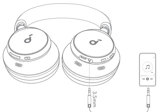
Reprodukujte zvuk na vanjskom uređaju priključivanjem 3,5 mm AUX kabla. Žičano slušanje će automatski isključiti Bluetooth način rada.
