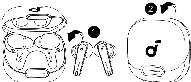
Da biste isključili slušalice, vratite ih u kutiju za punjenje i zatvorite je. Slušalice će se automatski isključiti nakon 30 minuta ako nisu povezane. Trajanje se može postaviti u aplikaciji soundcore.
