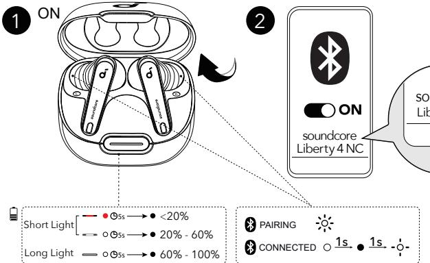
Otvorite kutiju za punjenje, slušalice će se automatski uključiti i ući u Bluetooth način uparivanja. Odaberite „soundcore Liberty 4 NC“ s Bluetooth liste vašeg uređaja prilikom prvog povezivanja.
