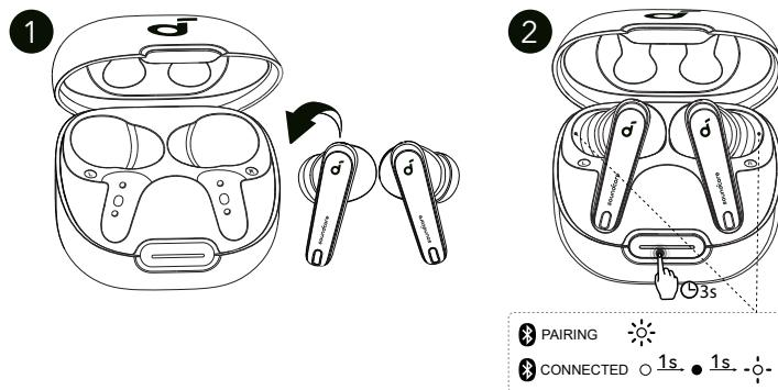
Da biste ručno ušli u način uparivanja putem Bluetootha, stavite slušalice u kutiju za punjenje i ostavite kutiju otvorenom. Pritisnite i držite gumb na kućištu za punjenje potpuno pritisnutim 3 sekunde dok LED indikatori ne počnu brzo treperiti bijelo.
