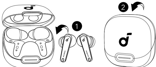
Za isključivanje vratite slušalice u kutiju za punjenje i zatvorite je. Slušalice će se automatski isključiti nakon 30 minuta ako nisu povezane. Trajanje se može postaviti u aplikaciji soundcore.
