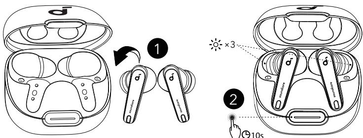
Resetirajte ako slušalice imaju problema s uparivanjem međusobno ili s drugim uređajima. Prvo izbrišite povijest uparivanja s vašeg Bluetooth uređaja. Stavite slušalice u kućište za punjenje i ostavite kućište otvoreno. Pritisnite i držite gumb na kućištu za punjenje 10 sekundi dok LED indikatori ne zatrepe brzo bijelo tri puta.
