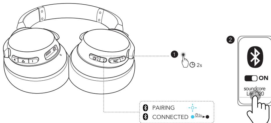
Zum Einschalten halten Sie die Ein-/Aus-Taste 2 Sekunden lang gedrückt. Die Kopfhörer wechseln automatisch in den Bluetooth-Kopplungsmodus, wenn Sie zum ersten Mal eine Verbindung herstellen. Wählen Sie „**soundcore Life Q20**“ in der Bluetooth-Liste Ihres Geräts aus, um eine Verbindung herzustellen. Während des Pairings blinkt die Anzeige an den Kopfhörern blau. Nach erfolgreicher Kopplung leuchtet die Anzeige 3 Sekunden lang und erlischt dann.
