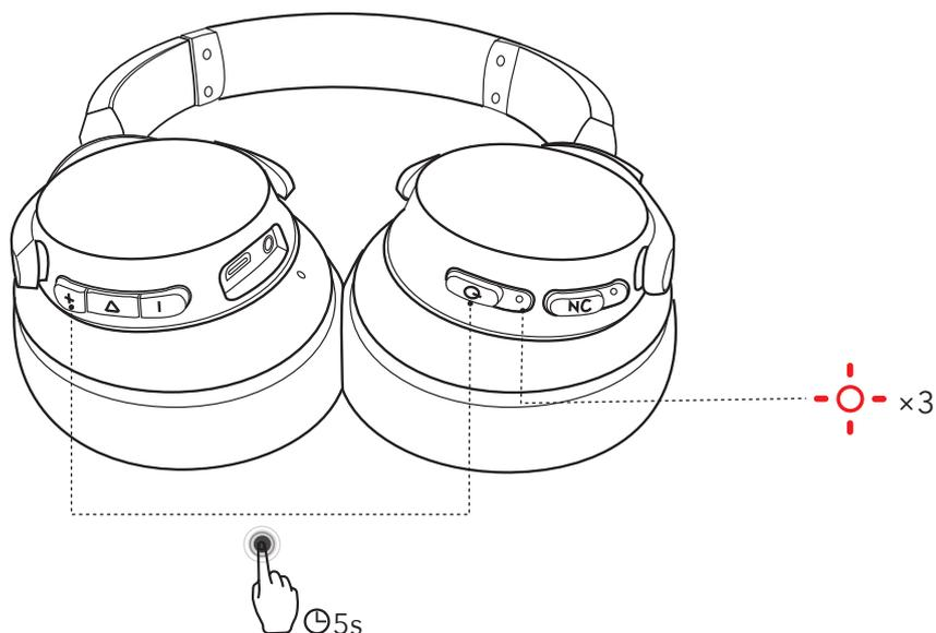
Falls Verbindungs- oder Funktionsprobleme auftreten, müssen Sie die Kopfhörer möglicherweise zurücksetzen.
