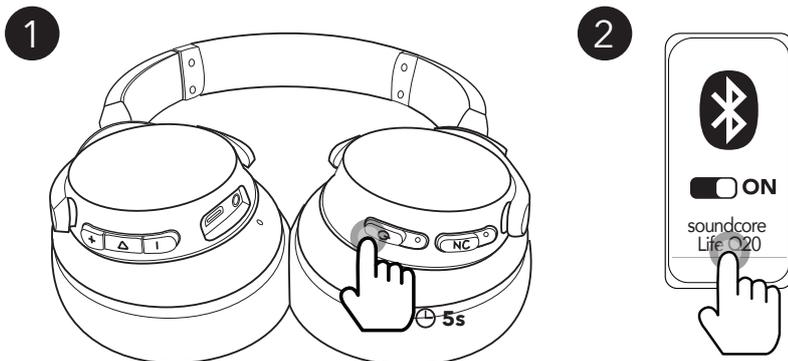
Para entrar manualmente en el modo de emparejamiento Bluetooth con los auriculares apagados, mantenga pulsado el botón de encendido durante 5 segundos hasta que el LED parpadee en azul.
