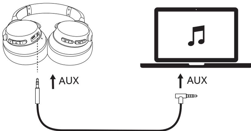
Reproduzca audio en un dispositivo externo conectando el cable AUX de 3,5 mm suministrado. La escucha con cable desactivará automáticamente el modo ANC y el modo Bluetooth.
