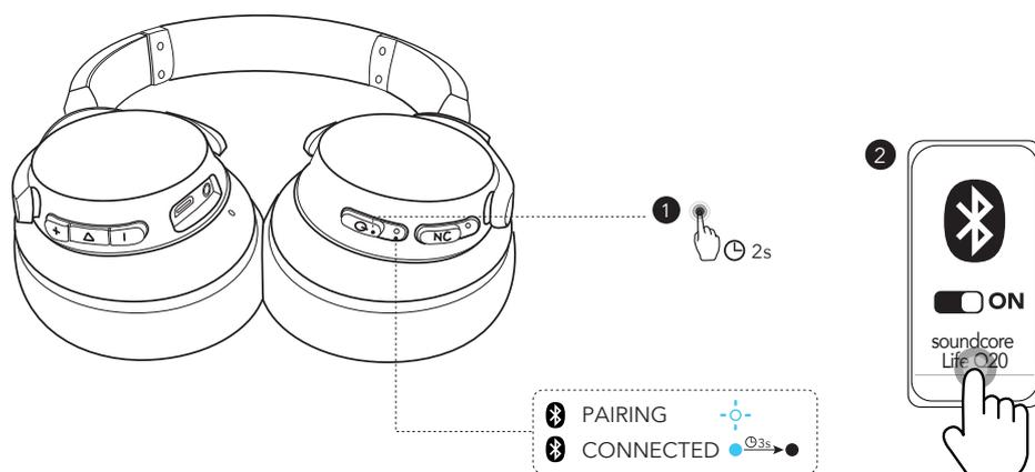
Tenere premuto il tasto di accensione per 2 secondi per accendere il dispositivo. Alla prima connessione, le cuffie entreranno automaticamente in modalità di abbinamento Bluetooth. Seleziona "**soundcore Life Q20**" nell'elenco Bluetooth del tuo dispositivo per connetterti. Durante l'associazione, l'indicatore sulle cuffie lampeggia in blu.
