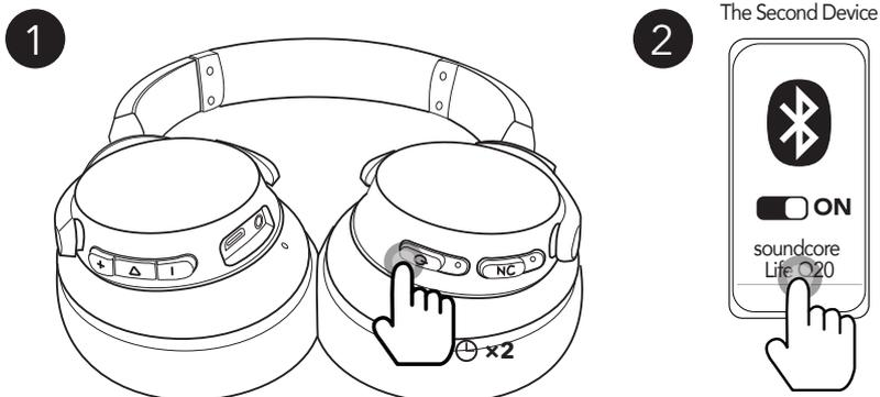
Una volta stabilita la connessione al primo dispositivo, premere due volte il pulsante di accensione per eseguire l'abbinamento a un altro dispositivo.
