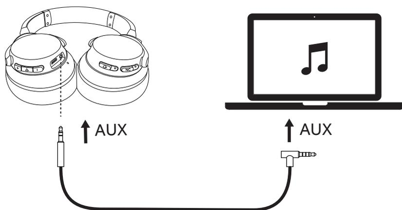
连接 3.5 毫米 AUX 纜線，使用外接裝置播放音樂。有線聆聽將自動關閉 ANC 和藍牙模式。
