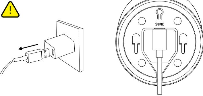
4. Für die Wandmontage legen Sie das Kabel in den Kabelkanal der Montageplatte.
