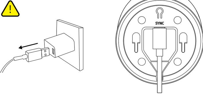
4. Para montar en la pared, coloque el cable en el canal del cable de la placa de montaje.
