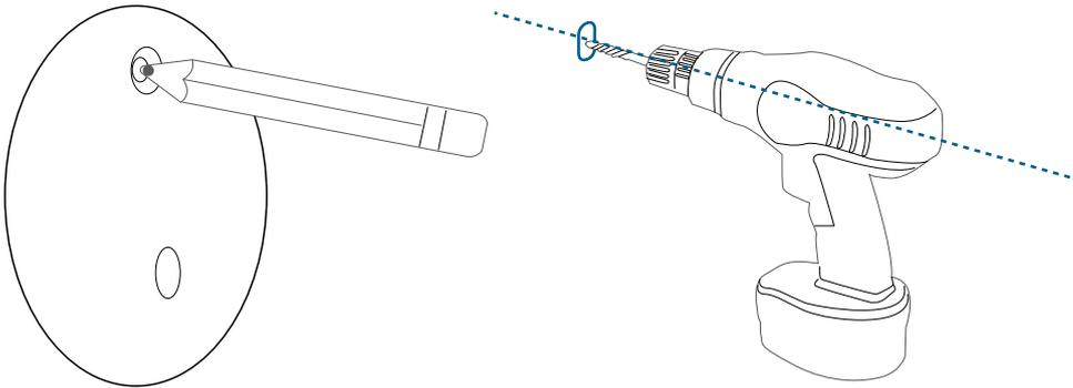
2. Sostenga la placa de montaje en la pared y asegúrese de que la flecha "UP" esté apuntando, luego fije la placa de montaje en la pared o el techo con los tornillos.
