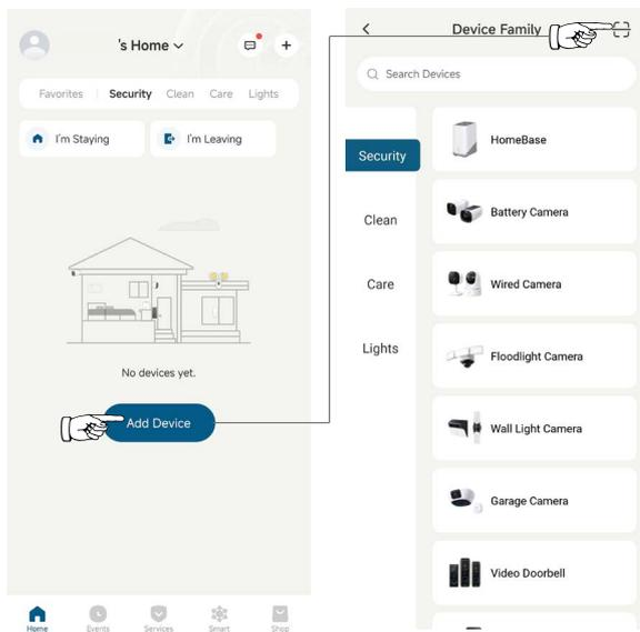
b. Toque Agregar dispositivo en la pantalla de inicio de la aplicación, luego seleccione Cámara con cable > Indoor Cam Pan&Tilt V2 > Indoor Cam C210 o Indoor Cam C220 y siga las instrucciones de la aplicación para completar la configuración.
