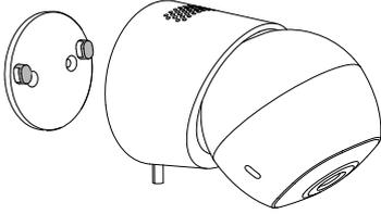
5. Deslice la cámara sobre la placa de montaje y asegúrese de que esté firmemente sujeta.
