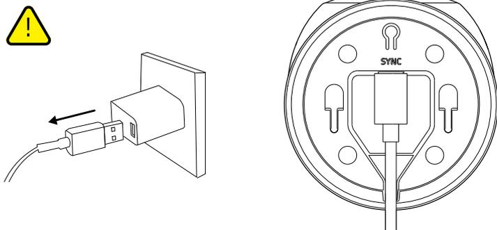
4. Per il montaggio a parete, posizionare il cavo nel canale del cavo della piastra di montaggio.
