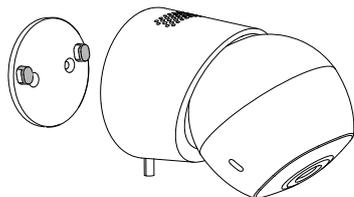
5. Inserisci la fotocamera sulla piastra di montaggio e assicurati che sia fissata saldamente.
