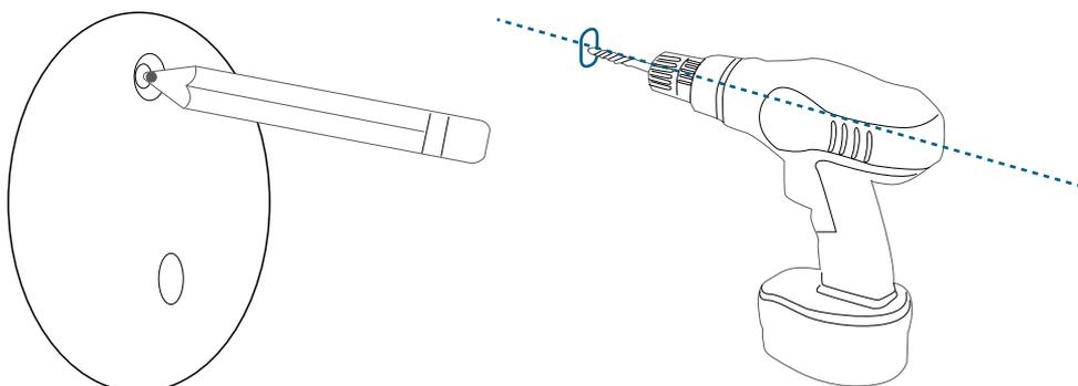
2. Tieni la piastra di montaggio sul muro e assicurati che la freccia "UP" sia rivolta verso l'alto, quindi fissa la piastra di montaggio al muro o al soffitto con le viti.
