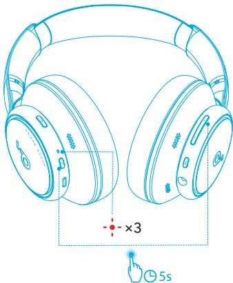
Možda ćete morati resetirati svoje slušalice ako imate problema s povezivanjem ili funkcijama. Najprije izbrišite povijest uparivanja s vašeg Bluetooth uređaja. Pritisnite tipke za uključivanje i povećanje glasnoće istovremeno na 5 sekundi dok LED ne zatreperi crveno tri puta.
