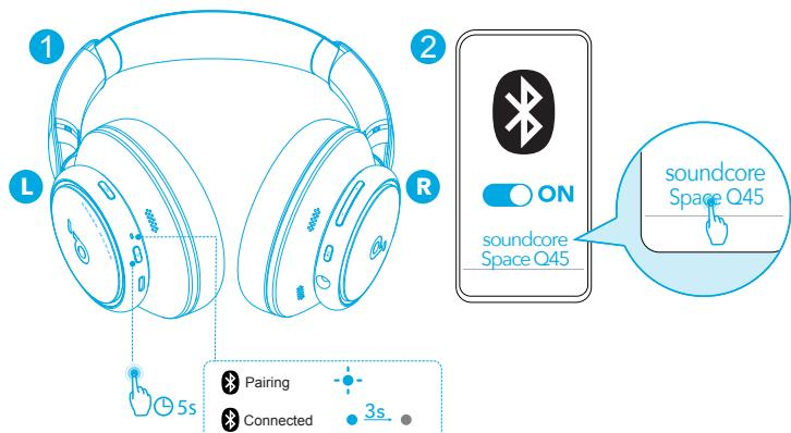
Kako bi ručno ušli u način uparivanja putem Bluetootha kada su slušalice isključene, pritisnite i držite tipku za uključivanje 5 sekundi dok LED svjetlo ne počne treperiti plavo.
