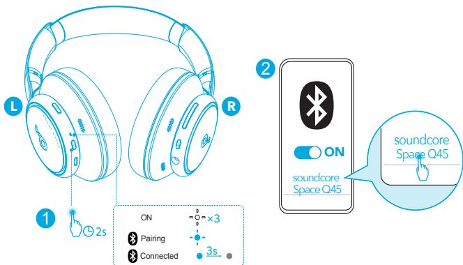
Pritisnite i držite tipku za uključivanje 2 sekunde za uključivanje. Slušalice će automatski uči u način uparivanja preko Bluetootha prilikom prvog povezivanja.
