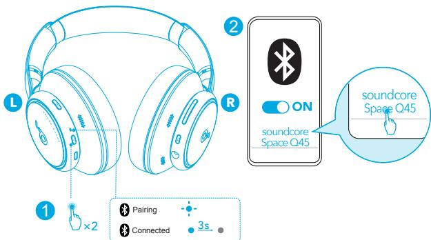
Slušalice se mogu istovremeno povezati s dva uređaja. Kad ste već povezani s jednim uređajem, pritisnite tipku za uključivanje dvaput kako biste se povezali s drugim uređajem.
