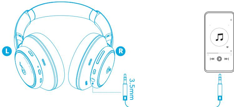
Reproducirajte zvuk na vanjskom uređaju spajanjem putem 3,5 mm AUX kabela. Slušanje putem žice automatski će isključiti Bluetooth način rada.
