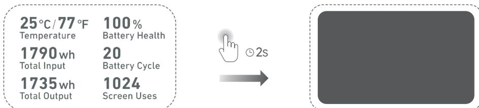
Na página de configurações "Desligamento Automático da Tela", pressione e segure o botão de energia por 2 segundos para alternar entre as opções.
